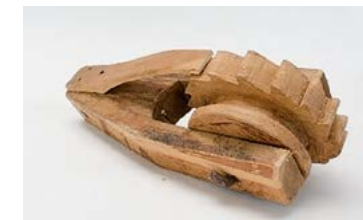
Przyrząd do podnoszenia uli kładowych na drzewa, zapadka uniemożliwiająca cofanie się koła (dł. zapadki 26,5 cm), kon. XIX w. – 1. poł. XX w., drewno, metal; dł. 37 cm, śr. 17,5 cm. Źródło: Muzeum Dawnego Bartnictwa, Strypejki, nr inw. SBM BĮ 120, https://www.limis.lt/valuables/e/
