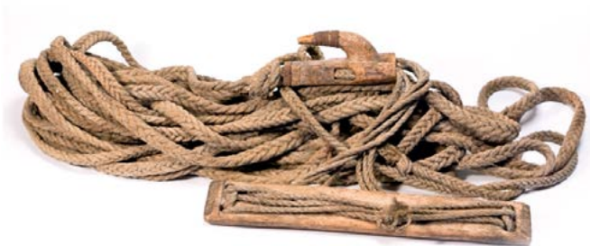
Leziwo, Marcinkańce, rejon orański, XX w.; lina konopna ok. 30 m do opasywania drzewa i wykonywania pętli, deseczka-siedzisko ok. 50 × 9 cm, hak z bloczkiem ( kumaragis ) do przewlekania liny, półokrągła płytka ( baronka ) o średnicy 9–10 cm z rowkiem do przesuwania liny. Źródło: Litewskie Muzeum Etnograficzne, Rumszyski; https://lemu.lt/etnografiniai-regionai/dzukija/daiktai/img/geinys.jpg
