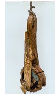
Podnośnik, przyrząd do podnoszenia uli kładowych na drzewa, kon. XIX w. – 1. poł. XX w., drewno, metal; dł. 50 cm, śr. 21 cm, grub. 5,5 cm. Źródło: Muzeum Dawnego Bartnictwa, Strypejki, nr inw. SBM BĮ 118, https://www.limis.lt/valuables/e/
